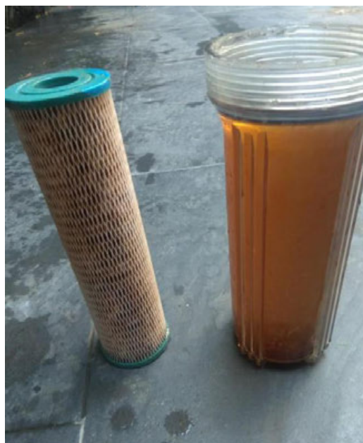
El filtro para eliminar impurezas no alcanza a limpiar el agua.
